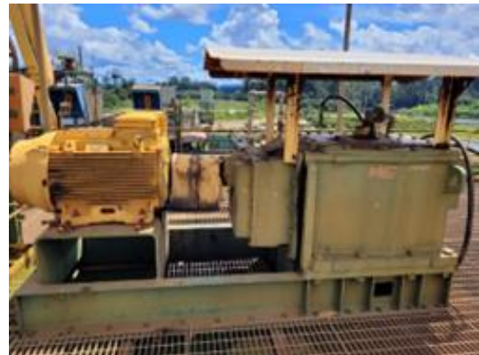
Figura 29 - Conjunto de agitadores para tanques detox
