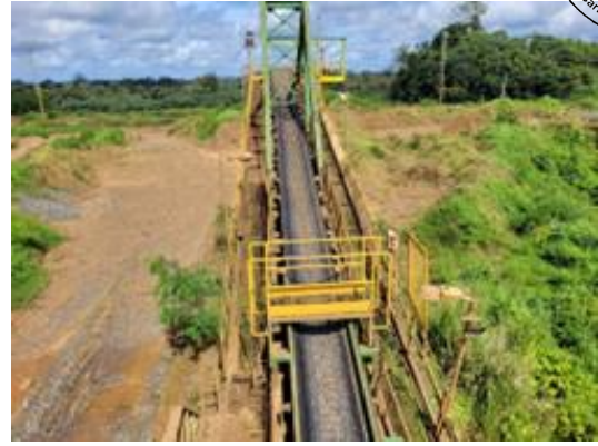
Figura 4 - Transportador de correia inclinado, dimensão 48" x 246m
