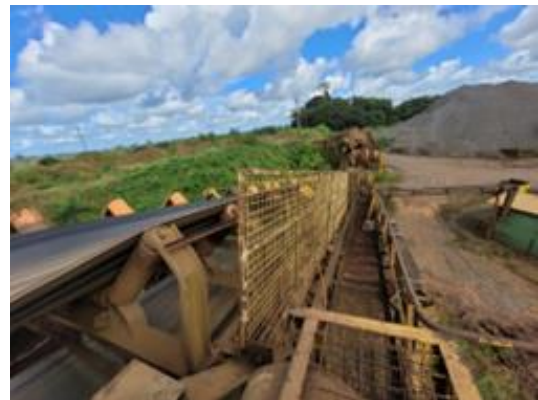
Figura 6 - Transportador de correia inclinado, dimensão 48" x 204,5m
