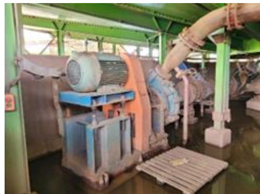
Figura 21 - Bomba centrífuga UF WEIR MINERALS modelo 10/8 F-AH R55/A05
