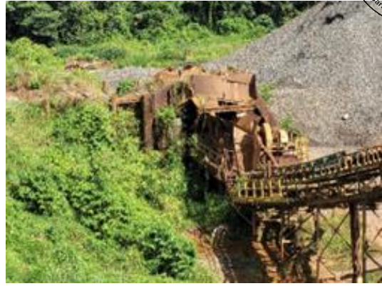
Figura 9 - Transportador de correia inclinado, dimensão 48" x 40m
