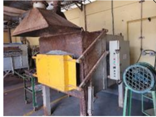
Figura 48 - Forno elétrico laboratório químico para copelação
