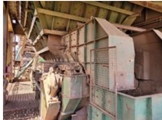
Figura 5 - Alimentador de sapatas com 2100mm TECNOMETAL
