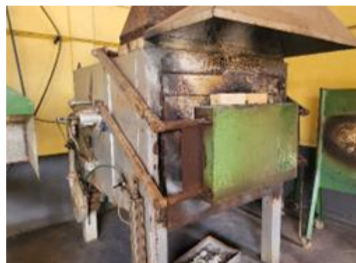
Figura 46 - Forno gás basculante para fundição DJ Fornos
