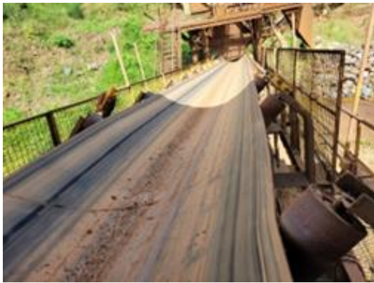
Figura 8 - Transportador de correia inclinado, dimensão 48" x 120m
