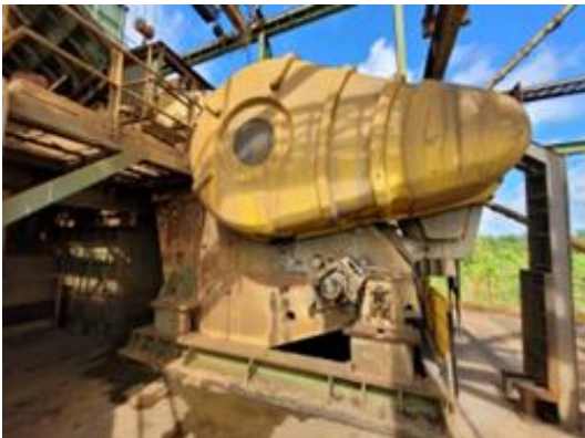
Figura 3 - Britador de mandíbulas METSO, modelo Nordberg C150, tamanho 55"x47", com capacidade de 880Mtp (acionamento de 300hp)
