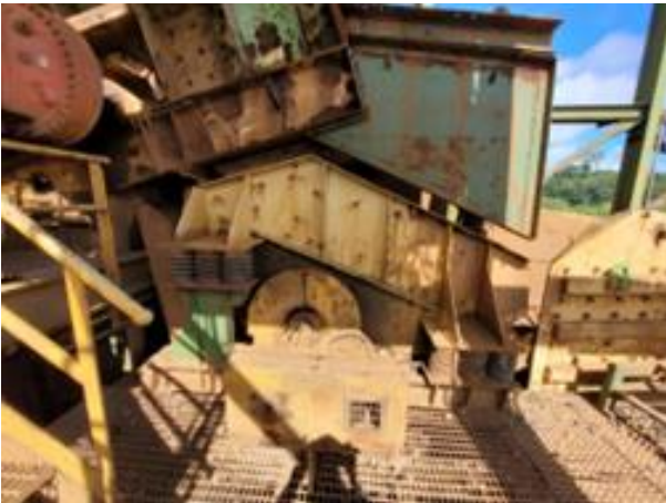
Figura 2 - Grelha vibratória METSO-OUTOTEC, com 2 decks (com acionamento de 30HP – 220/380/440v)
