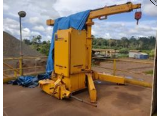
Figura 17 - Sistema de Martelo hidráulico sem ressalto RUSSEL
