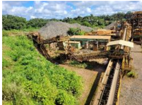
Figura 10 - Transportador de correia inclinado, dimensão 48" x 67m
