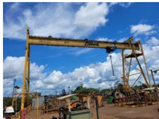
Figura 23 - Ponte rolante Eilbeck Cranes
