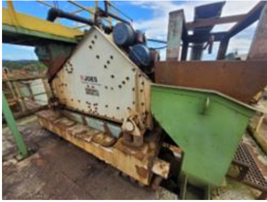
Figura 30 - Peneira vibratória de recuperação de carvão carregado JOEST – MAVI
