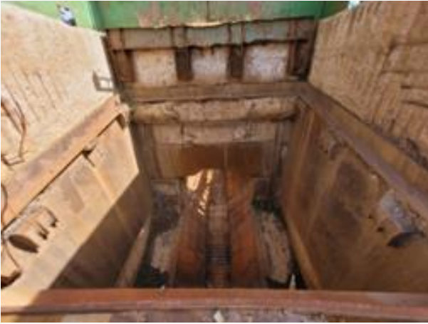
Figura 1 - Alimentador de sapatas TEREX modelo PBRK 12/70 D4 (com acionamento de 60CV - 440V WEG)
